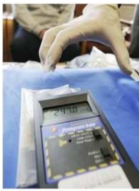
福島南相馬市の駐車場で採取された土壌の上で、毎時2.47マイクロシーベルトを示す線量計＝20日午前、南相馬市
